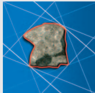
Der Vorteil der beim CAMSIZER eingesetzten Full-Frame-Kameras, welche die Partikelprojektionen verzerrungsfrei in ihrer Ganzheit erfassen, zeigt sich besonders bei der Vermessung der Kornform.
