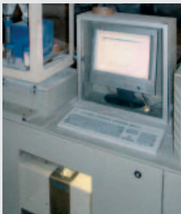
Kapselung des CAMSIZER für extreme Betriebsbedingungen
