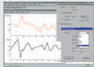
Trendanalyse von Produktionsprozessen Bis zu 4 frei wählbare Kenngrößen des Probenmaterials können dauerhaft überwacht werden
