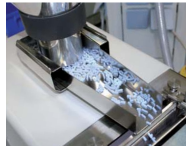
Automatische Probenzuführung im CAMSIZER
