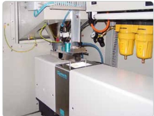
CAMSIZER-Online mit integriertem Ionisator zur Verbesserung der Fließfähigkeit der Probe
